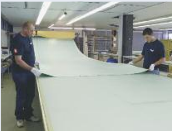
Folie auf Mängel prüfen Checking the vinyl for possible defects
