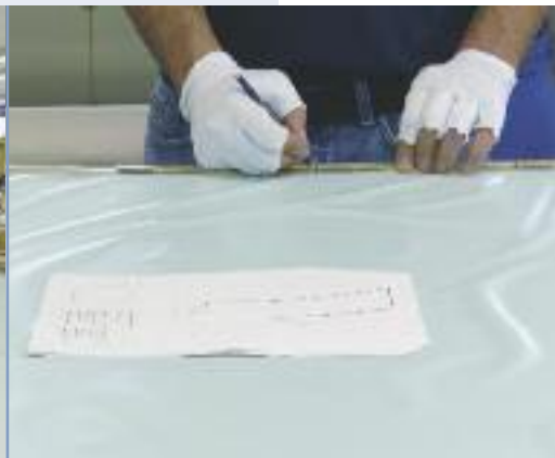
Maße vom Deckenproduktionsplan übertragen Copying the measurements from the ceiling production plan
