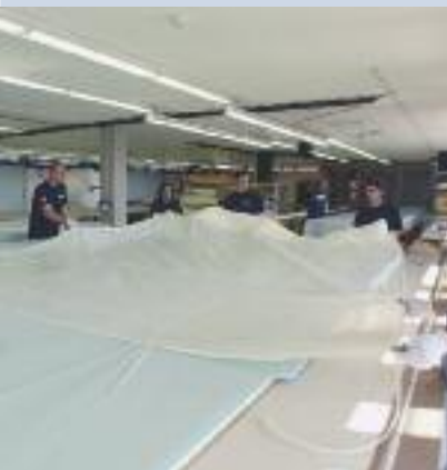
Vorbereitung zum Keder Preparing the rim-reinforcement
