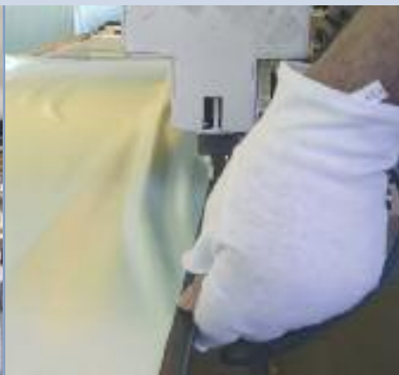
Keder mit Folie verschweißen Welding the rim-reinforcement with the vinyl
